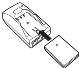
Аккумулятор необходимо устанавливать до конца и в правильной ориентации, как показано на иллюстрации. Аккумулятор не будет правильно заряжаться, если положительные и отрицательные клеммы аккумулятора и зарядного устройства не будут совмещены или будут прилегать неплотно. Следите за тем, чтобы аккумулятор не был вставлен под углом.
